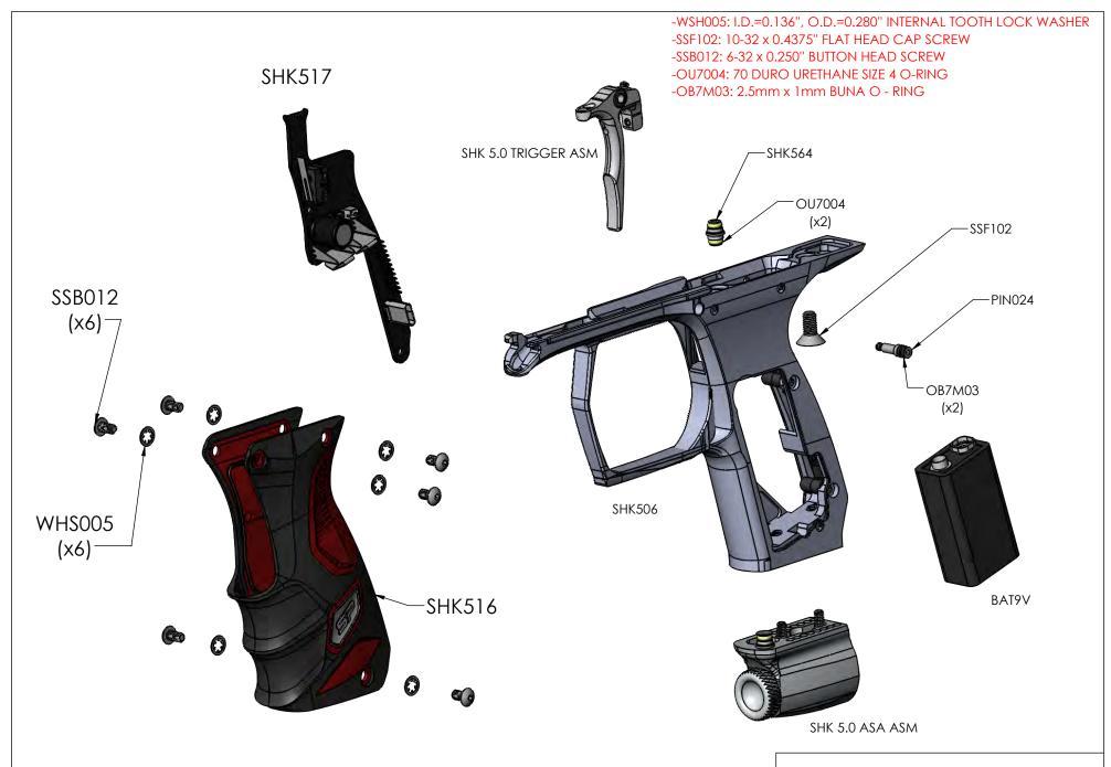
SHOCKER 5.0 TRIGGER FRAME ASM
